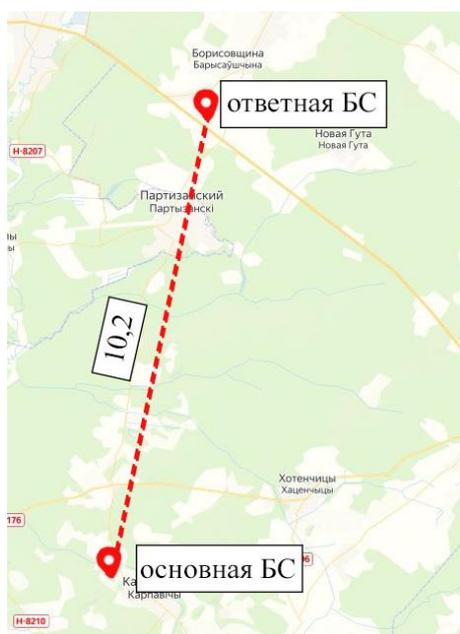
Рисунок 7 – Схема радиорелейного пролета
